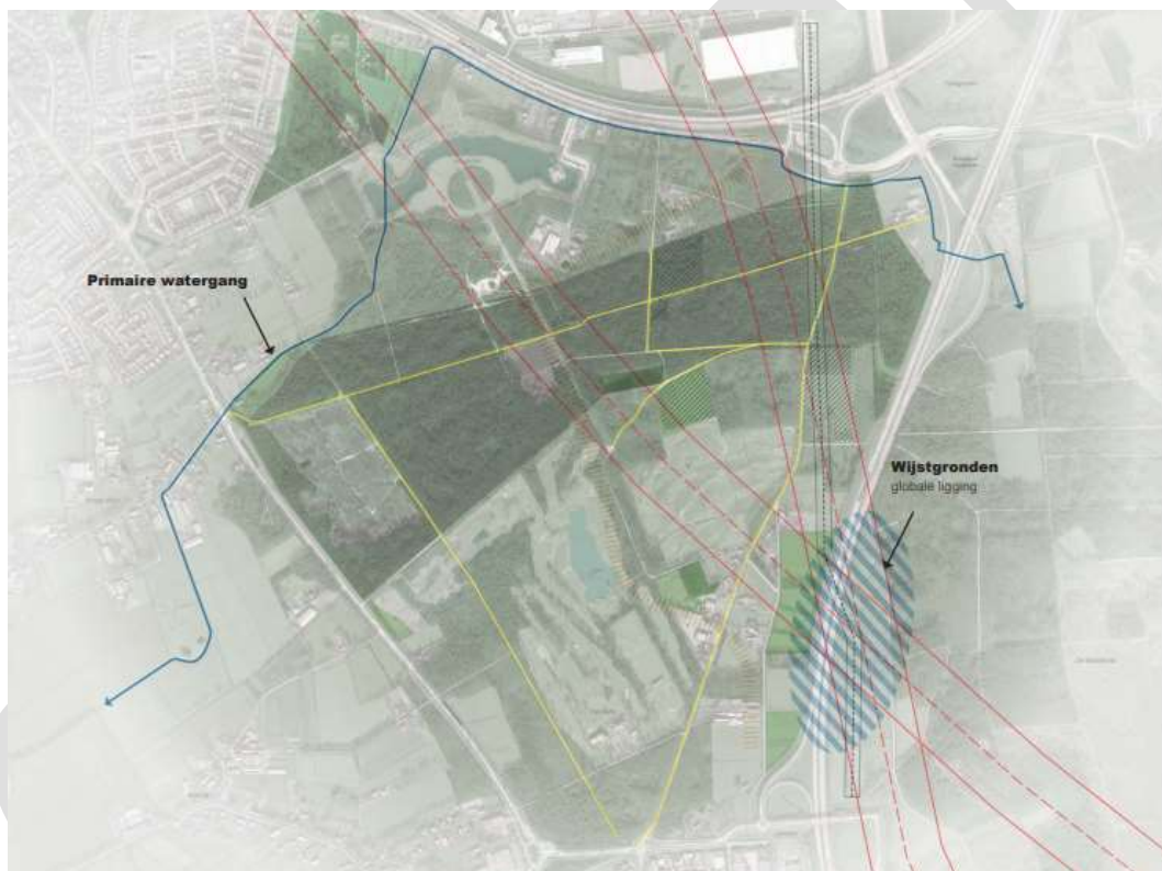
Figuur 2.2. Ruimtelijke kaders als gevolg van het bodem- en watersysteem. Geschatte Breuklijnen en Steilrand in de Hooge Vorssel. In rood staan de twee breuken: de Raambreuk en de Hoofdbreuk. De exacte ligging van de breuken zijn onzeker, wat wordt aangegeven door de bandbreedte van c.a. 200m om de breuklijnen heen. Daarnaast weergeeft de oranje stippellijn op de kaart een plots hoogteverschil in het landschap door de breuken. Dit is de Steilrand.
